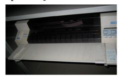
Nadeldrucker DLQ 3000 - Drucker - Farb-Nadel; A3 360 dpi x 360 dpi: 24 Nadel - bis zu 444 Zeichen/Sek. - parallel, seriell Anschluss
